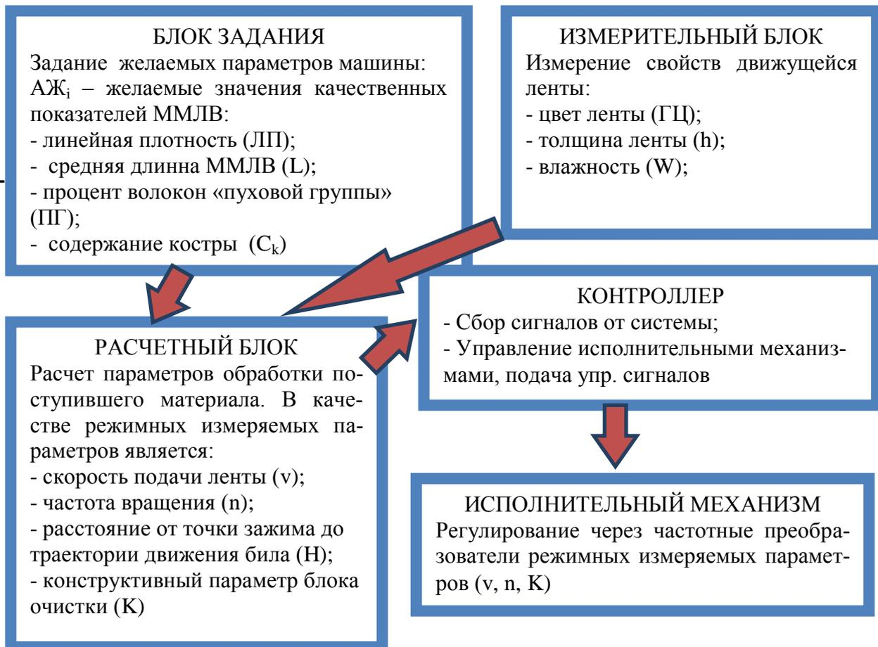
Рис. 2. Алгоритм реализации технологии получения ММЛВ, основанной на применении системы адаптации режимных параметров к свойствам перерабатываемой льняной ленты
